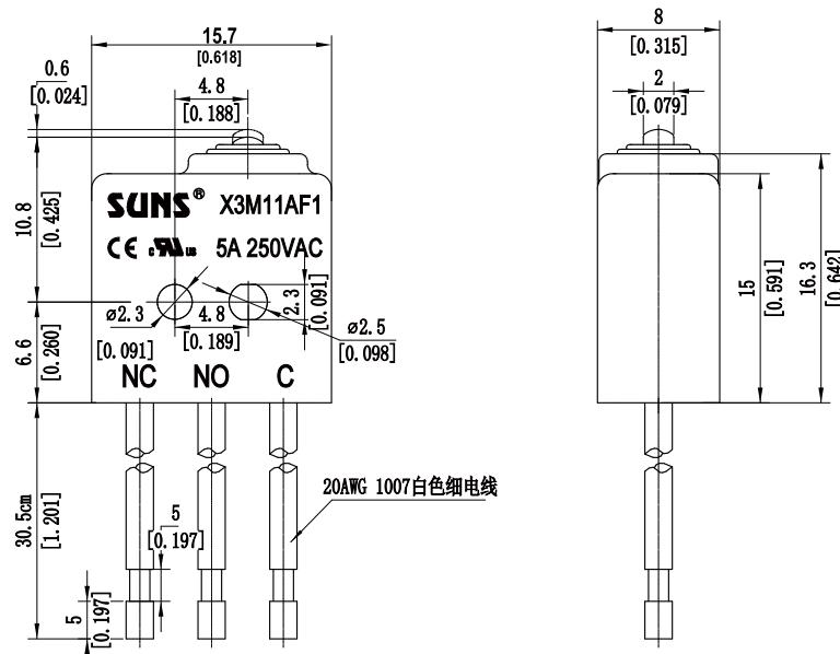
\*X3M系列为密封导线款，适用于端子形式A，并应在型号中说明导线长度
